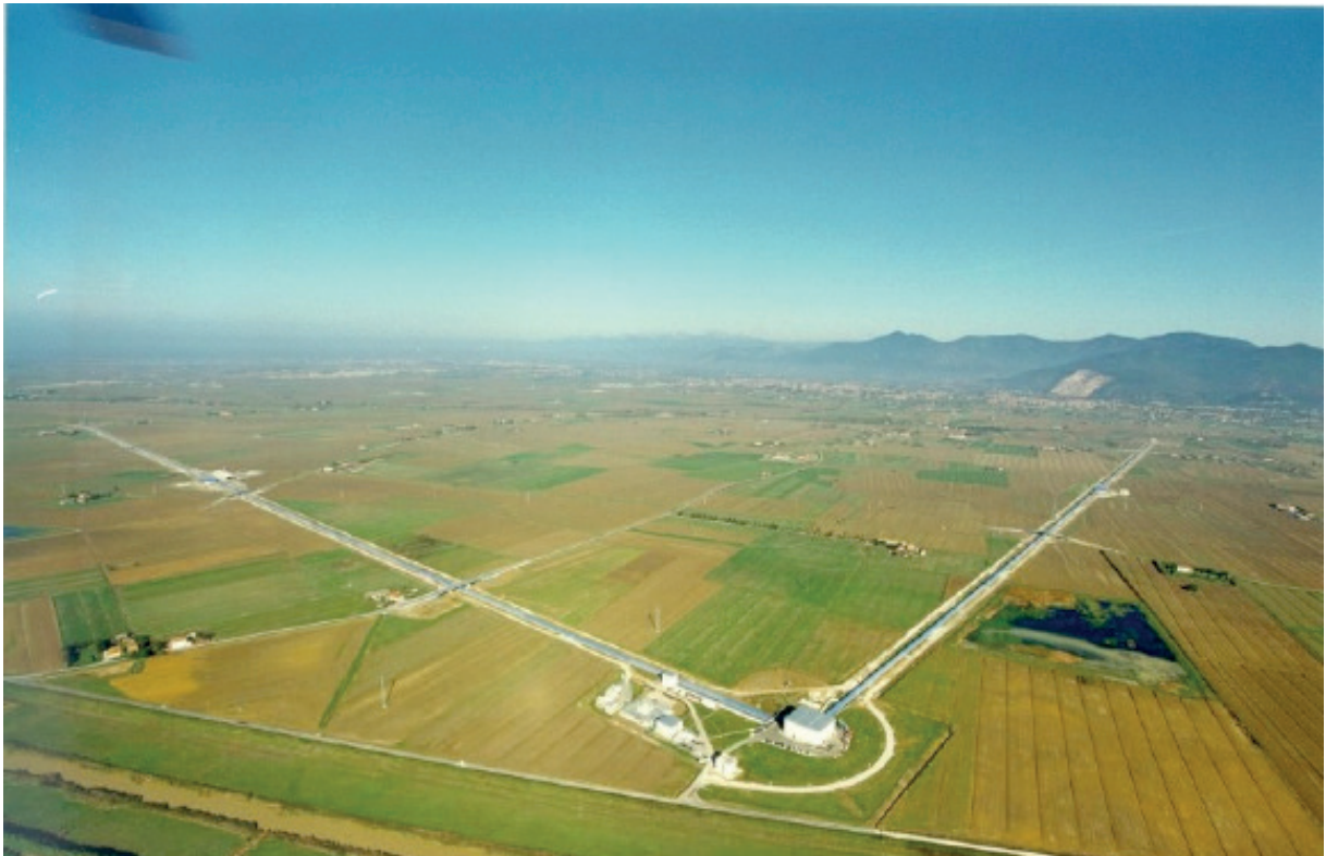
Fig. 8. Interferometro di Virgo è situato a Cascina, in provincia di Pisa. I suoi bracci hanno una lunghezza di 3 km.
